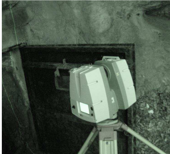
2 ábra: Leica C10 lézerszkennő (Forrás: Molnár Bálint)
